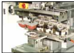
- Fijación DPS lanzadera de tampón multi-color.
