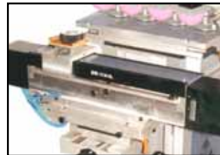
- Lanzadera neumática (2-4 colores)
