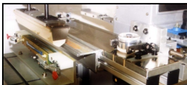
- Tintero lateral para la impresión de imágenes largas (SCMIC).
